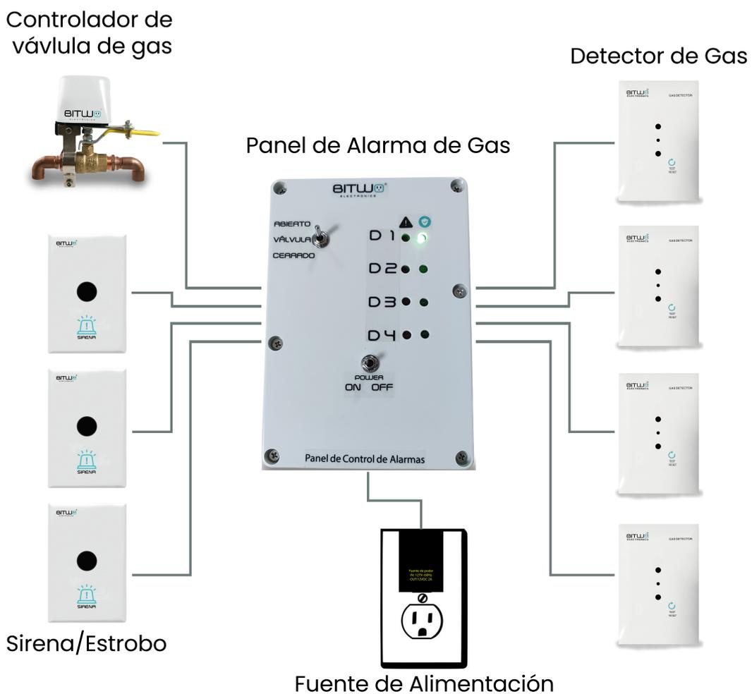
**Figura 1. Esquema de conexión HUB y periféricos.**
